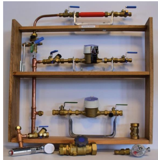
Proefopstelling terugstroom beveiliging in collectief leidingnet
